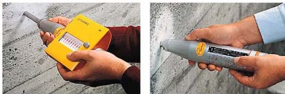
شکل (۸-۱): چکش بازگشتی اشمیت برای تعیین مقاومت فشاری و یکنواختی بتن
