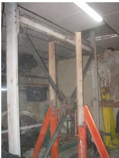
الف: آزمون میراگر اصطکاکی ب: آزمون قاب مهاربندی شده شکل ۳: آزمون دوره‌ای انجام شده روی مهاربند اصطکاکی در آزمایشگاه سازه دانشگاه صنعتی شریف
