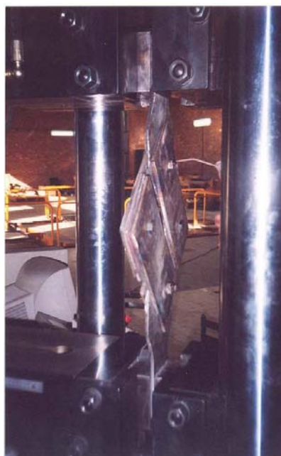
الف: آزمون میراگر اصطکاکی ب: آزمون قاب مهاربندی شده شکل ۳: آزمون دوره‌ای انجام شده روی مهاربند اصطکاکی در آزمایشگاه سازه دانشگاه صنعتی شریف
