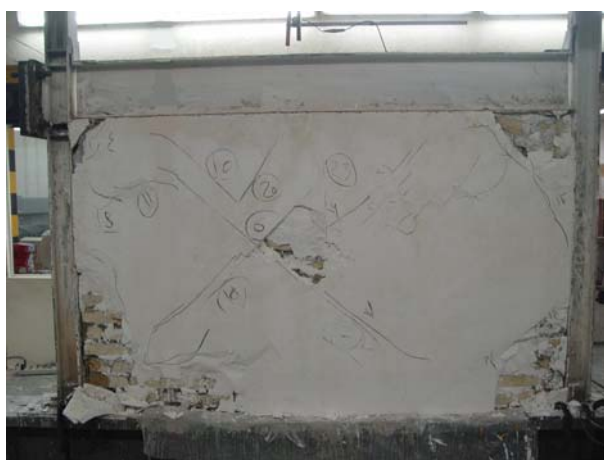
شکل ۴ نمایی از موقعیت ترکها بعد از آزمایش
