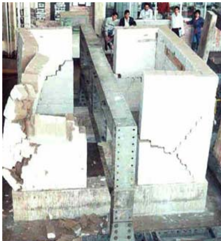
شکل ۱۲ - مقایسه تأثیر نیروی زلزله بر دیوارهای خشتی مسلح با نوار شبکه فلزی و دیوارهای مشابه غیرمسلح
