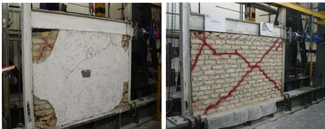
اشکال ۱۰ نمایی از موقعیت ترک پشت دیوار قبل و بعد از طرح بهسازی
