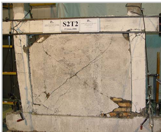
شکل 6: نحوه شکست قاب‌های دارای میانقاب اجرایی
